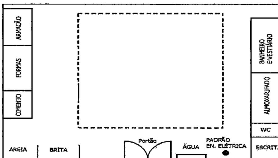
Os profissionais que irão compor o canteiro de obras são divididos em áreas de vivência e áreas operacionais, esses componentes dependem do porte da obra e serão dimensionados pelo engenheiro de acordo com as especificações da norma e necessidade da obra.
